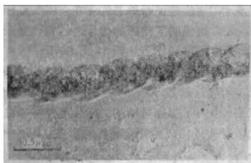
图 7 PPTA 单个微纤结构的透射电子显微照相
